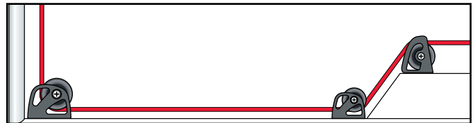
Rinvio Over the Top: I bozzelli speciali "Over the Top" sono necessari quando le manovre devono fare percorsi non usuali come un angolo esterno di una cabina o della mastra.
